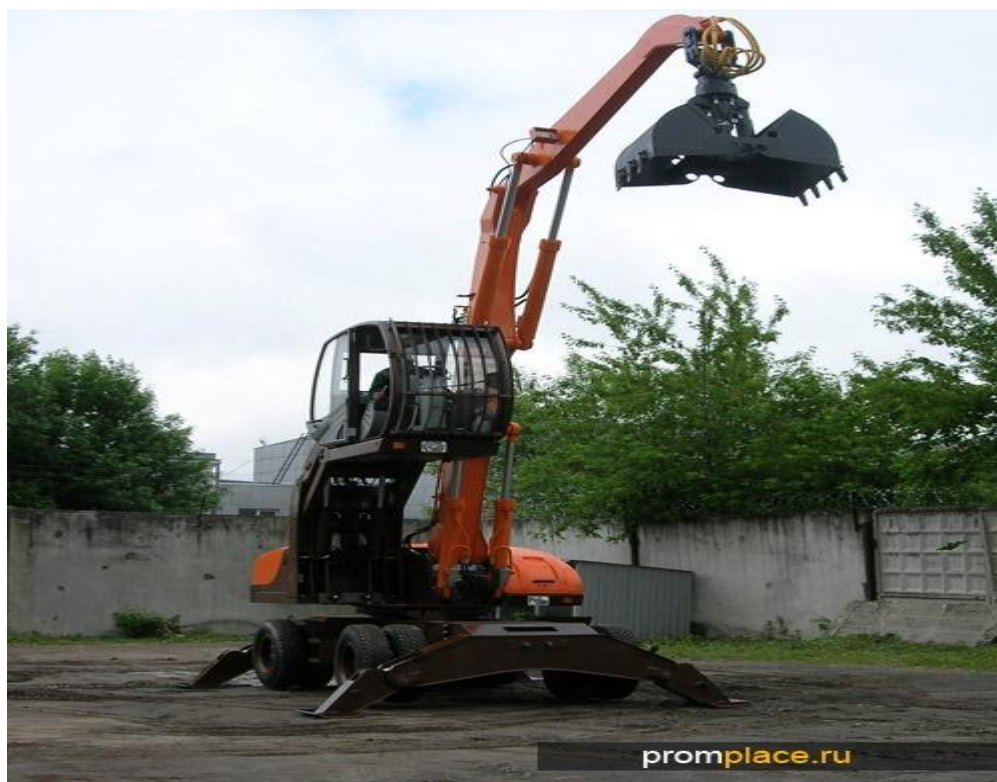
3.1-сурет – Жүк көтергіш грейфер механизмі
